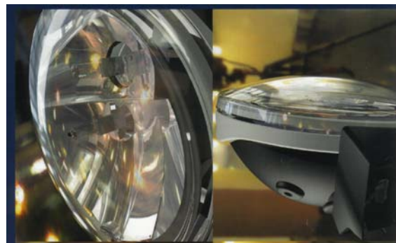
Simulation von Reflektoren mit Ray-Tracing
